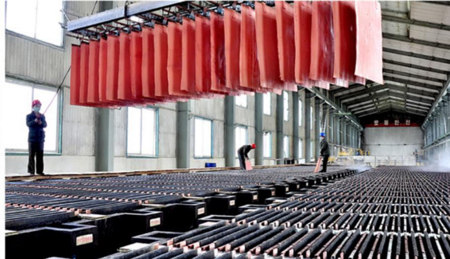
Процесс производства электролитической меди.
